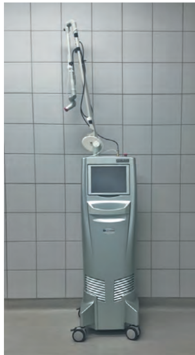
Рис. 1. CO 2 -лазер (Lumenis AcuPulse 40ST)
